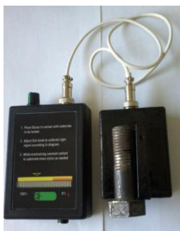
Рисунок 2 – Пристрій для контролю наявності тріщин в нарізних з'єднаннях
