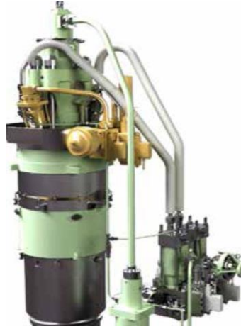
Рисунок 2 Кришка циліндрів, оснащена інжекторами паливних підсилювачів та блоком керування LGI (всі труби паливного блоку є двостінними)
