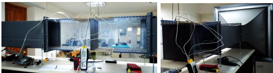
Рисунок 1. Загальний вигляд експериментального стенду – розімкненої аеродинамічної труби дозвукостей швидкостей
