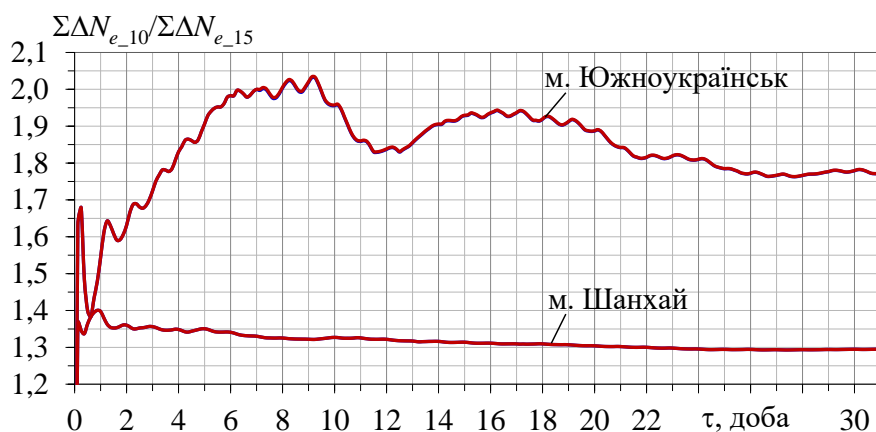
Рис. 4. Значення відношення приросту корисної потужності \Sigma\Delta N_{e_{10}}/\Sigma\Delta N_{e_{15}} при порівнянні охолодження повітря у комбінованій холодильній машині до 10 °С та у АБХМ до 15 °С за липень 2017 р. для м. Южноукраїнськ, Україна та м. Шанхай, КНР
