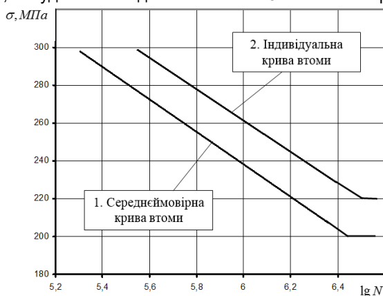
Рис. 4. Розташування середньоїмовірної і індивідуальної кривих втоми в координатах \lg N - \sigma
