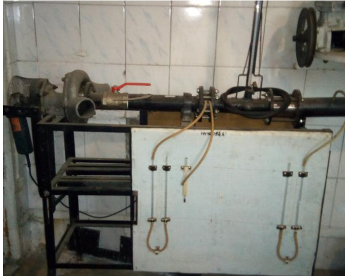
Рисунок 2 – Стенд для дослідження характеристик відцентрового компресора.
