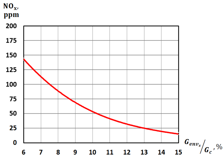
Рис. 1 – Залежність викидів оксидів азоту від витрати екологічної пари відносно витрати повітря через компресор
