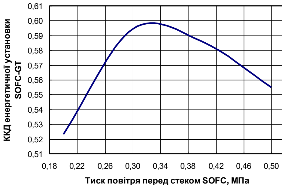
Рис. 3. Залежність ефективності установки SOFC-GT від тиску повітря на вході в стек
